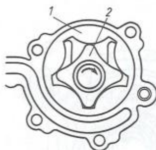
Obr. 85. Rotační olejové čerpadlo 1 – vnější rotor, 2 – vnitřní rotor
