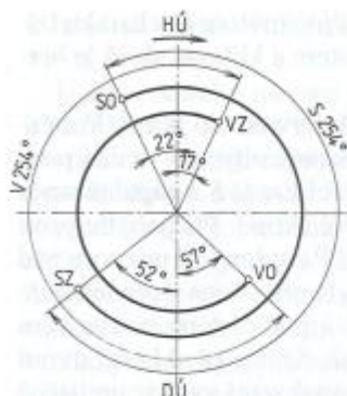
Obr. 80. Diagram časování ventilového rozvodu čtyřdobého zážehového motoru S - sání, V - výfuk, SO - sací ventil se otevírá, SZ - sací ventil se zavírá, VO - výfukový ventil se otevírá, VZ - výfukový ventil se zavírá, DÚ - dolní úvrat, HÚ - horní úvrat
