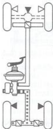
Obr. 153. Rozdělení systémů ABS Varianta III: ABS se 3 kanály a 3 snímači
