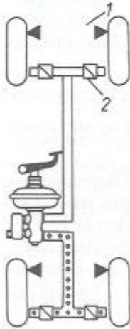
Obr. 151. Rozdělení systémů ABS podle počtu kanálů a snímačů Varianta I: ABS se 4 kanály a 4 snímači, rozdělení přední část - - zadní část, 1 - snímač, 2 - ovladač (magnetický ventil)
